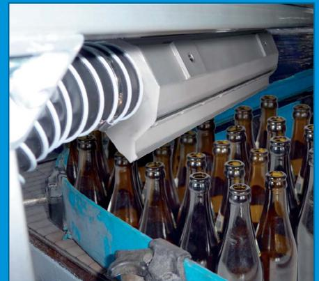
Trocknung nach der Flaschenreinigung
