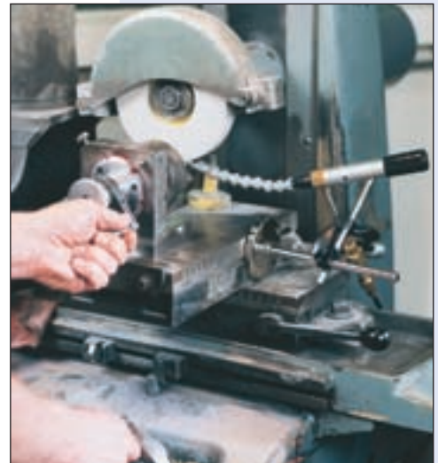
Drastische Verkürzung der Fertigungszeiten beim trockenen Flachsleifen mit der Mini-Kaltluftpistole Modell 608BSP.
